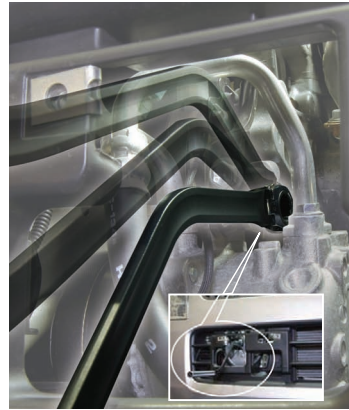
只需拆下车牌即可进行作业, 从而大幅缩短了作业时间。
