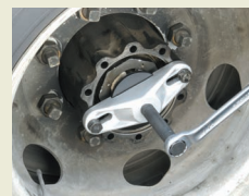
*作业时需使用梅花扳手（对边宽度为27mm）或带榫类工具的套筒扳手（另售）。
